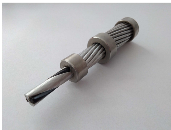
Obrázek 1: Řez kombinovaným zemním lanem
